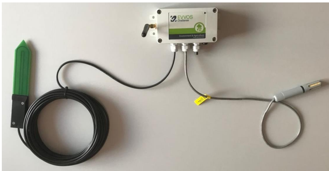
Abbildung 7-1: Sensoreinheit der Firma Evvos mit Sigfox-Modul und zwei Sensoren für Bodenfeuchte, Bodentemperatur, relative Luftfeuchtigkeit und Außentemperatur 24
