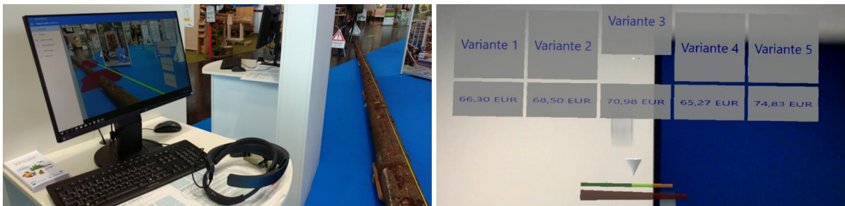
Abbildung 7-14 Die HoloLens ermöglicht es, die Ertragsunterschiede je nach Wahl der Einteilung eines Baumstamms zu visualisieren. Rechts ist eine zusammenfassende Ansicht gezeigt, die dem Nutzer auch seinen Standort entlang des Stamms anzeigt 52
