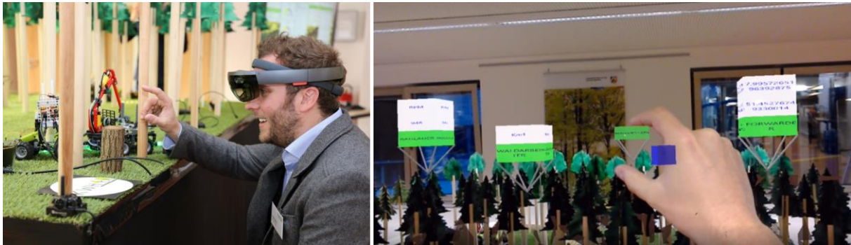
Abbildung 7-13 Die HoloLens-App bezieht ihre Daten zum dargestellten gamifizierten Smart Forest Lab (s. Abschnitt 9.2) über verschiedene Schnittstellen in Echtzeit aus den angeschlossenen Maschinen und zeigt sie im Blickfeld des Benutzers an 51
