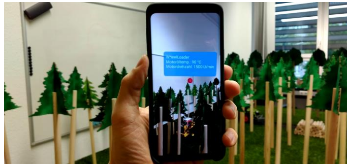
Abbildung 7-15 Die im Rahmen des gamifizierten Smart Forest Labs (Abschnitt 9.2) vorgestellte AR-App zeigt hier die Position und Betriebsdaten einer Forstmaschine an 54
