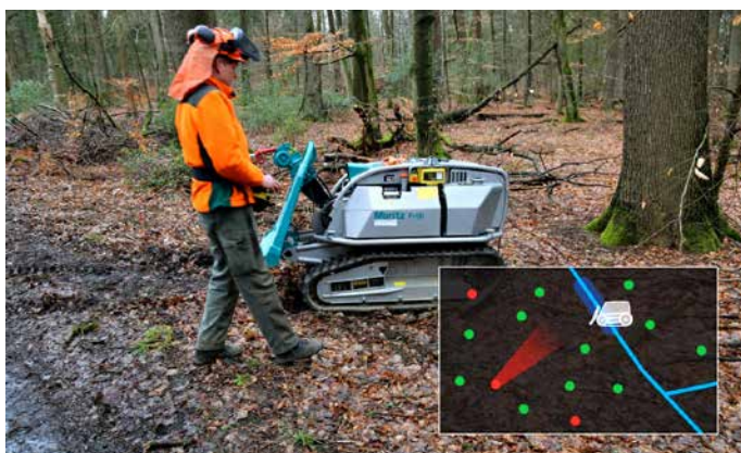
Abb. 5: Fällraupe Moritz Fr 50: Positionierungsvorschlag (blau) für Fällhilfeaufnahme mit zu fällenden Bäumen (rot) und Fällrichtung (roter Trichter)
