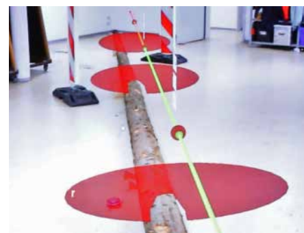
Abb. 2: Wertoptimierung von Rohholz durch digitale Vermessung im Schlag mittels einer Holens als Möglichkeit der modernen Datenvisualisierung
