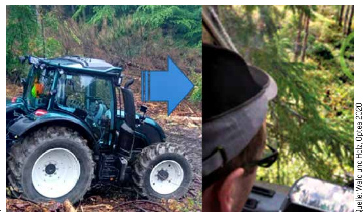
Abb. 6: Der Rottenschlepper Valtra N 134 eA – Forstedition soll mit einem Head mounted display des schwedischen Herstellers Optea erprobt werden.
