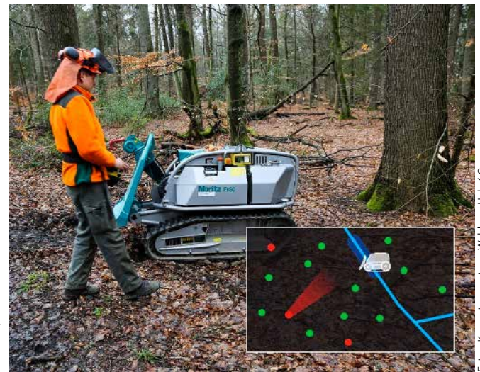
Abb. 2: Positionierungsvorschlag (blau) für Fällhilferaupe mit zu fallenden Bäumen (rot) und Fällrichtung (roter Trichter)
