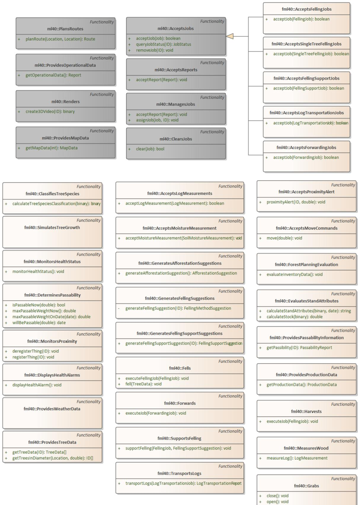
Abbildung 5-3: Featurekatalog von (f)m140 – Servicefunktionen (die Basisklasse **Functionality** wird aus Gründen der Übersichtlichkeit nicht explizit gezeigt)
